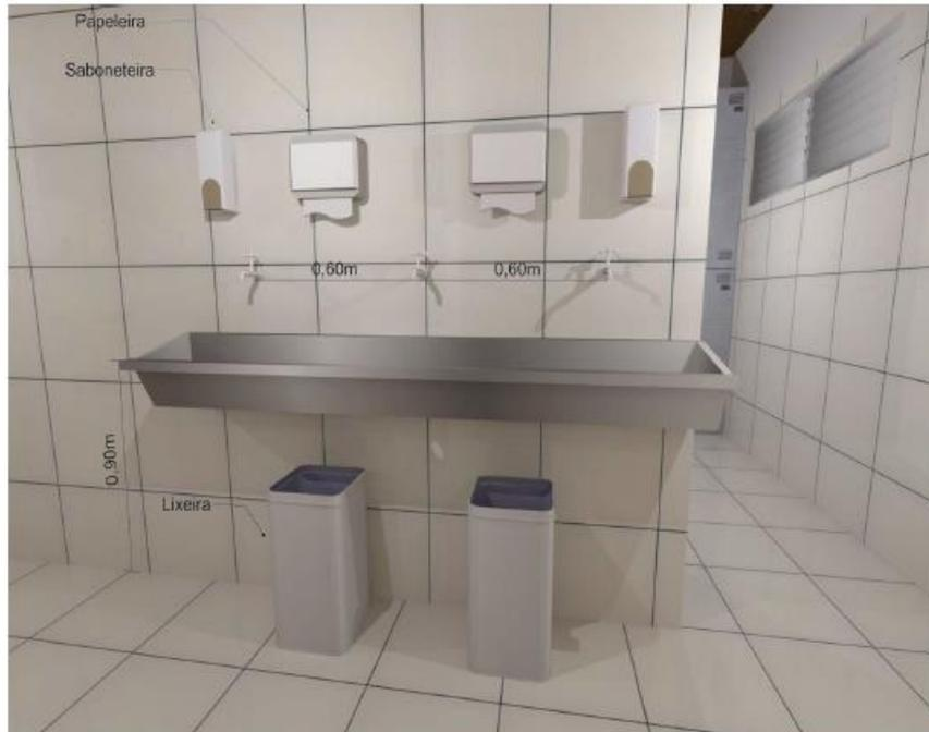
Figura 3: Padrão desejável de instalação de lavatório tipo calha
