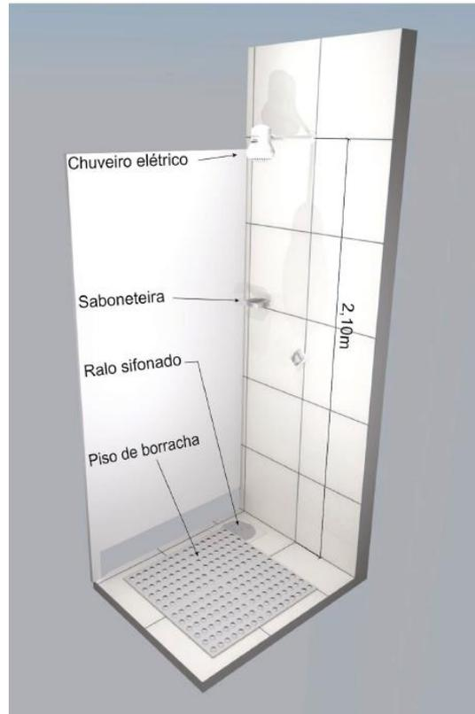
Figura 4: Padrão desejável de instalação de chuveiro
